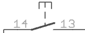
Abbildung 1.4i: Schaltzeichen eines Tasters (Schließer)
